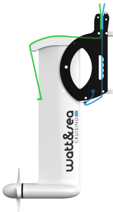
Schéma de montage des bouts d'immersion et de relevage
